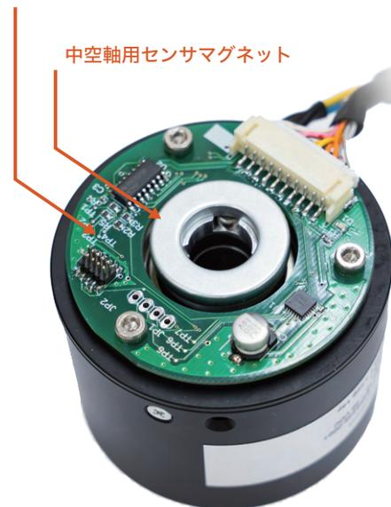
磁気式回転角度センサ基板搭載例
